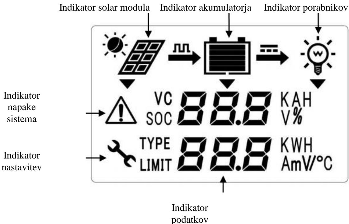
Dva LED indikatorja na zgornji strani zaslona prikazujeta polnjenje akumulatorja, v primeru da zasveti rdeč indikator je napaka v sistemu.
