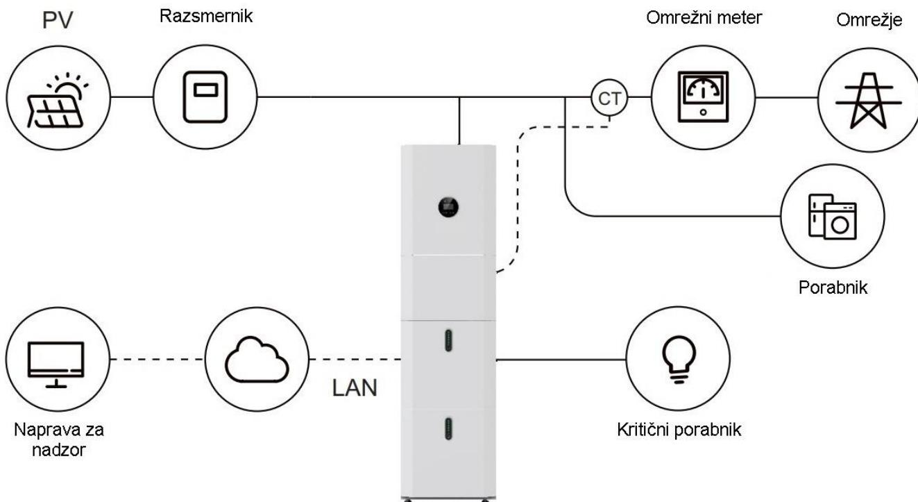
V obstoječo sončno elektrarno se vgradi Kstar hranilnik s kapaciteto 10kWh, 20kWh, 30kWh ali 40kWh. Del viškov energije, ki bi se sicer odvajal v omrežje, se shranjuje v baterijah. S tem se lahko poveča lastna poraba solarne energije do 80%. Na UPS izhod se povežejo tisti porabniki, ki morajo nujno delovati v vsakem primeru.
